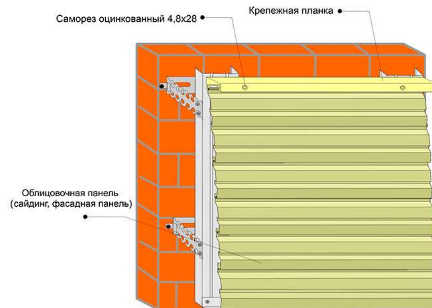
Рис.10 Завершение монтажа: обрамление крепежной планкой
